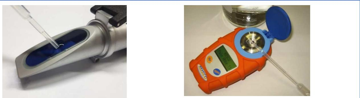
2) Vlastní kalibrací. Optický refraktometr se kalibruje na nulu pomocí šroubováku, kterým se utahuje/uvolňuje závit nad měřícím hranolem. Digitální refraktometry se kalibrují automaticky po zvolení funkce kalibrace (podrobně viz vlastní metodika, kapitola 2.7.3.)
