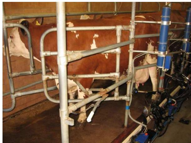
Kontrolujte průběh dojení. Především pokud vemeno není zcela čisté. (Foto špatné polohy strukových násadců).
