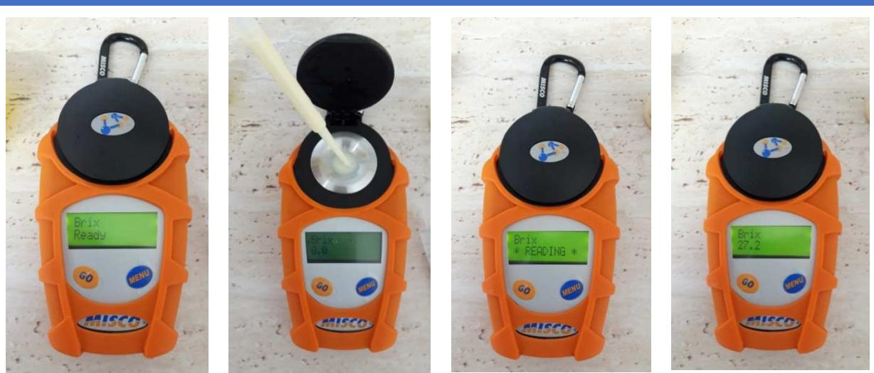
Příklady dvou výsledků v optickém refraktometru: vlevo mlezivo velmi nízké kvality (necelých 13 % Brix), vpravo od něj mlezivo výborné kvality (téměř 28 % Brix).
