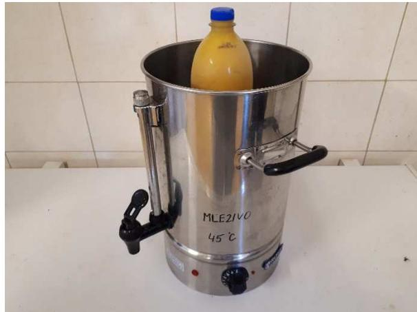
K rozmrazování, ohřevu, příp. pasterování mleziva se u kazetových systémů používají specifické jednotky s vodní lázní.
